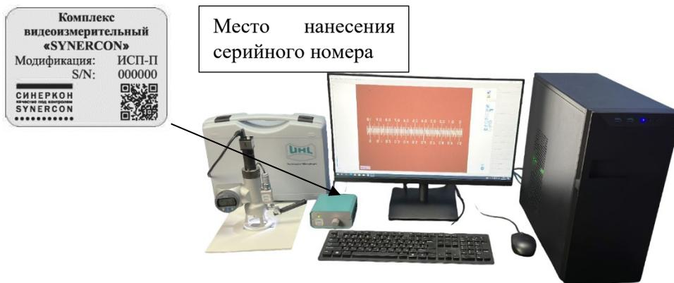
Рисунок 3 – Общий вид комплекса видеоизмерительного SYNERCON модификации ИСП-П и место нанесения серийного номера
