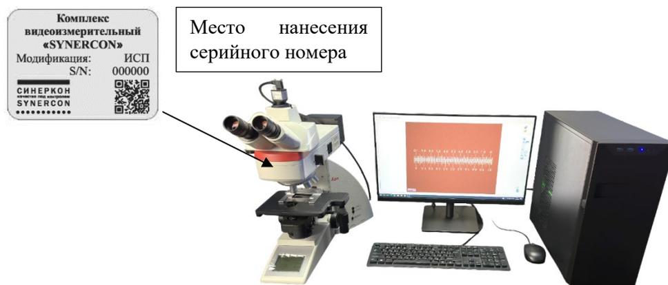
Рисунок 2 – Общий вид комплекса видеоизмерительного SYNERCON модификации ИСП на базе микроскопа плоского поля прямого типа и место нанесения серийного номера
